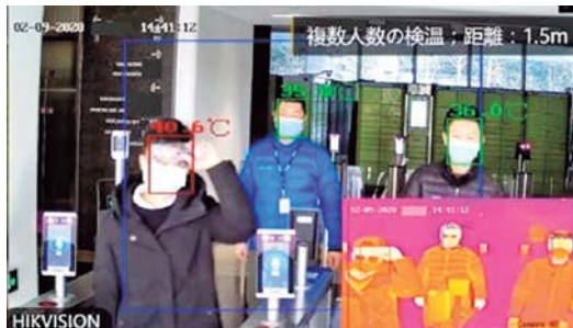
青枠内に入れば瞬時に温度表示し、設定温度を超過した場合、顔の部分を赤く表示
